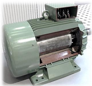
图 1：感应电机的定子与转子 (1)
