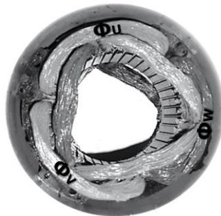
图 2：定子中的分布式绕组
