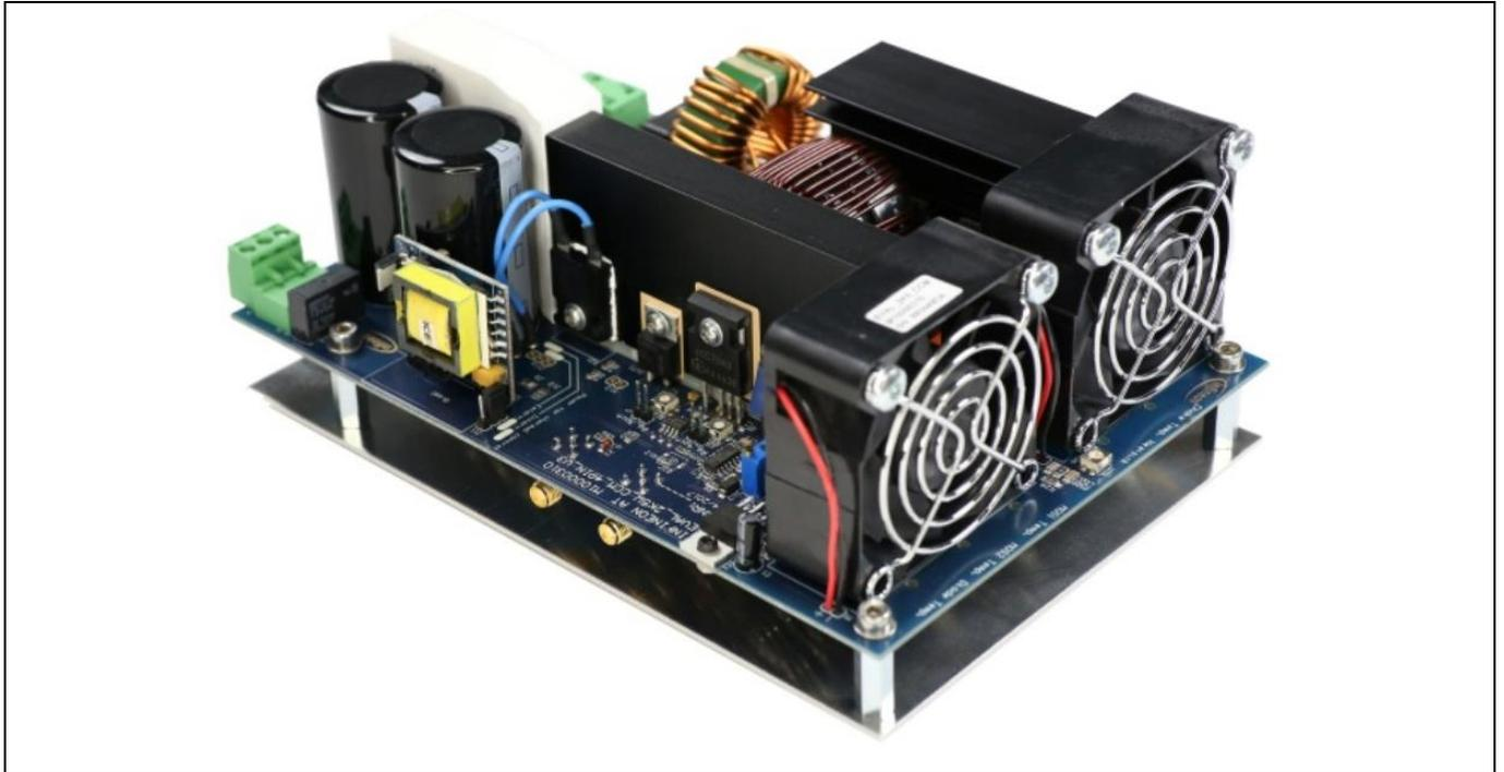
**Figure 33** PFC 评估板（用于确定所示效率测量值）照片。此演示板可在 [www.infineon.com](http://www.infineon.com) [18] 的“EVAL\_2k5W\_CCM\_4P\_V3”下订购。
