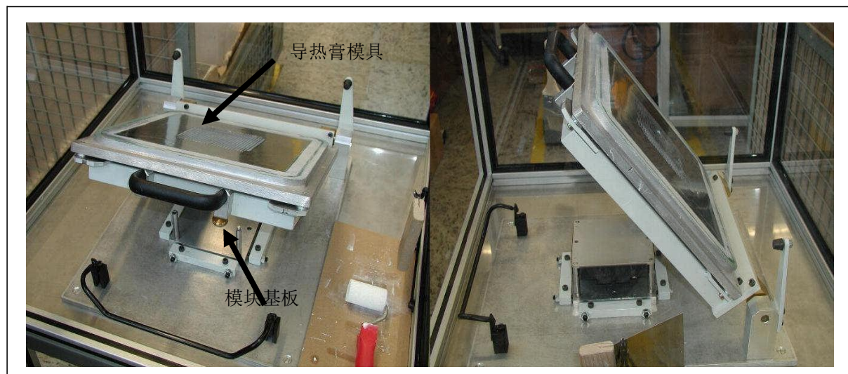
图. 6: 丝网印刷过程中使用敷涂夹具敷涂导热膏示例，模块基板细节
