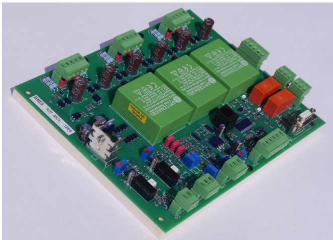
图 28. 用于 BLE 晶闸管转换器的控制器和触发电路 ISR06ZL
