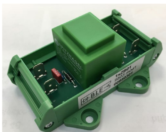
图 20. 触发变压器 ZB01，脉冲持续时间为 1ms，线电压有效值为 500V（高*宽*深 = 36*85*65mm）。
