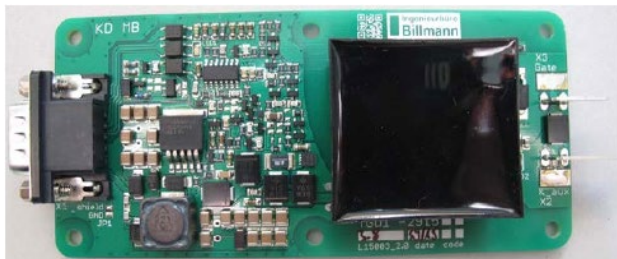
图 25. 长脉冲状态信号触发电路 TGD1
