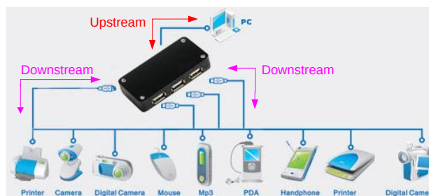
图 3. 多个外设同一个主机相连
