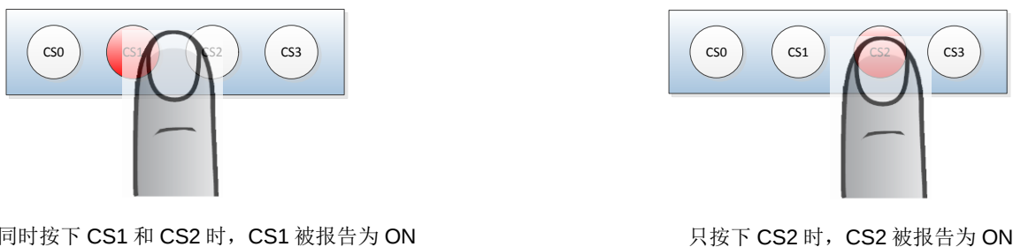
图 5-2. 有多个按键被按下时的 FSS（其中，只有第一个按键的状态为 ON）
